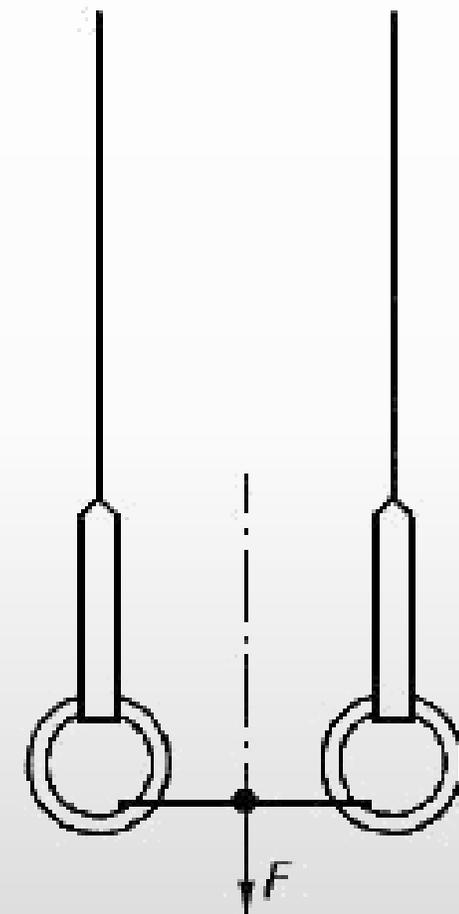
Рис. 5. Определение прочности закрепления гимнастических колец
