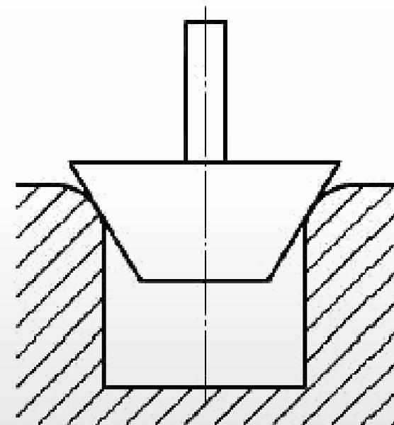
Рис. 9. Проверка соответствия оборудования требованиям к обеспечению предотвращения застреваний частей тела
