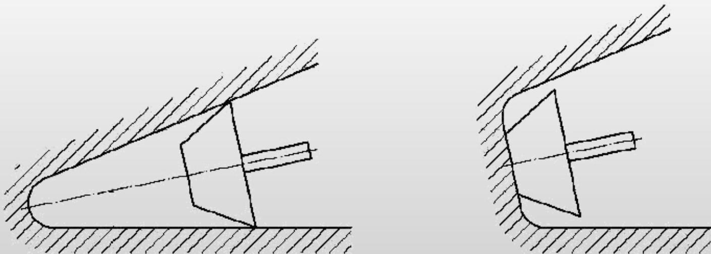
Рис. 10. Проверка соответствия оборудования требованиям к обеспечению предотвращения застреваний частей тела
