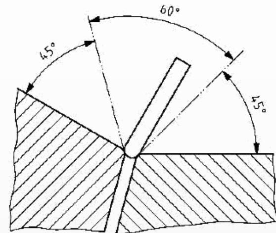
Рис. 11. Проверка соответствия оборудования требованиям к обеспечению предотвращения застреваний частей тела
