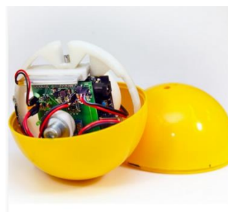
Устройство для изучения движения твердого тела с беспроводной передачей данных
